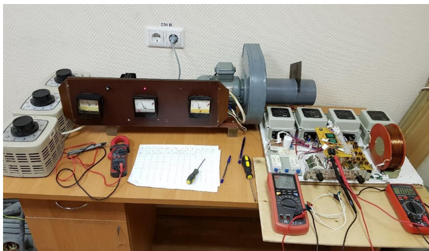
Рисунок 13 – Лабораторний стенд для дослідження несиметричних режимів роботи АД
